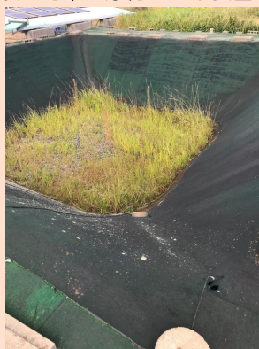
【廃棄物大型立体実験槽】 汚染された土壌を地中で浄化させる装置
